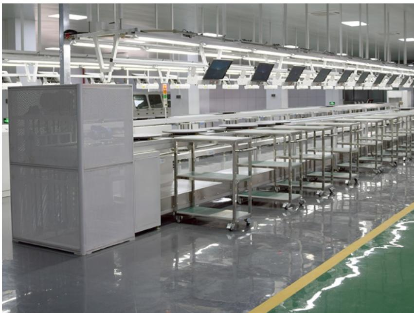
三倍速链筒输送线是一种普遍应用于自动化总装生产线的输送设备。其机械部分主要由驱动机头（马达、牙箱、传动链轮等）、输送段、张紧机尾及电控箱等几部分组成。也可以根据产品工艺需要配置专机或辅机，以完成需要的功能。各工位按照工位工艺指导书要求，完成各自相应工作，输送线属自动运行，可配置成强制节拍或自由节拍，以保证较高的生产率。维护保养：一级维护保养：日常维护保养主要由岗位工完成，每天进行。每天上班开机前检查有无物料、工具、杂物堆放在输送线上，有无杂物卡住链条影响正常运行；观察电器控制部分是否有烧损现象，急停按钮是否在允许开机运行位置；在以上工作完成后，才能开始点试启动一至二次，正常再开机运行工作；每天下班前停机后，对输送线各工作区清理因当天工作时留下的各种废渣，特别不要使材料、工具或废渣掉入链条中，以免影响正常运行、发生损坏等事故。自从有了流水线以后，很多人都会感觉到平时的工作变得轻松了许多。扬州组装倍速线
