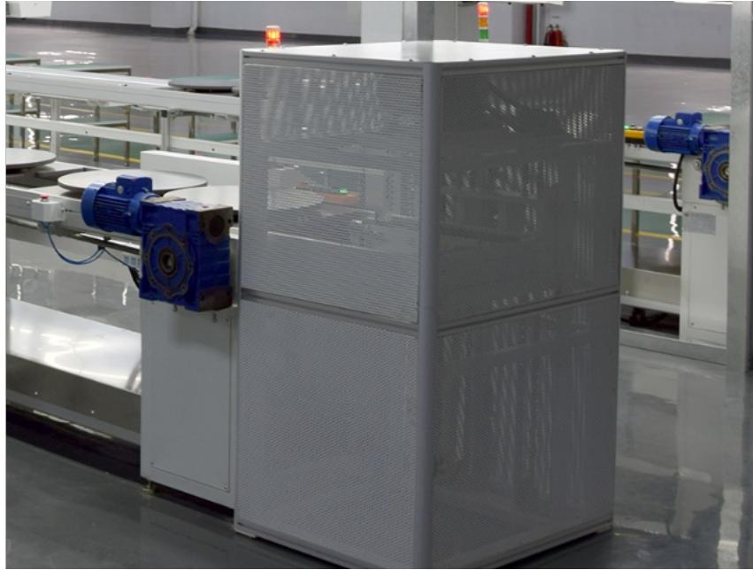
倍速链组装线结构原理：本系统由送料差速链、回空板差速链、五个顶升移载机构、六条动力滚筒线、工装板五部分组成。1、输送部分送料和回空板差速链靠摩擦带动工装板运行。2、顶升移载工装板到位后，送料差速链上的1、2、3号顶升移载机构的顶升气缸会自动上升，上升到位后，移载马达会根据操作指令自动换向。3、动力滚筒输送部分各工位进货或送货时，动力滚筒会根据操作指令自动换向。倍速链组装线操作流程：1、打开压缩空气开关，在储气罐压力达到六公斤以后打开气阀开关，给线体供气。2、检查送料顶升移载台在无工装板时是否下降到位，回空板顶升移载台在无工装板时是否上升到位，如没有请按故障排除方法排除。3、在正常使用情况下，1、2、3号顶升移载机构上不能停留工装板，回空板顶升移载台也不能停留工装板。
