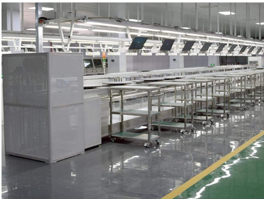
倍速链物流线应用在那些领域，倍速链输送线普遍应用于：柴油机、家用电器、食品、汽车、电动车、摩托车、空调器、冰箱、洗衣机、电控柜、发动机等行业的装配及输送。电子装配倍速链流水线：用途普遍，输送平稳耐油，耐腐蚀，防静电结构简单，便于维护能耗较小，使用成本低适应性强，运作可靠高效低燥；动作原理：倍速链流水线的运作原理：运用倍速链条增速能力，驱动工装板（工装板用来承托所需输送的货物）快速运转，所输送货物之积放动作，移行，转位，转线等功能可以通过工业控制器的预定指令来操作，停止功能则通过操作阻挡器到预定位置。扬州组装倍速线倍速链流水线能保证链流水线的匀速前进，以确输送带上材料的精确同步输送。
